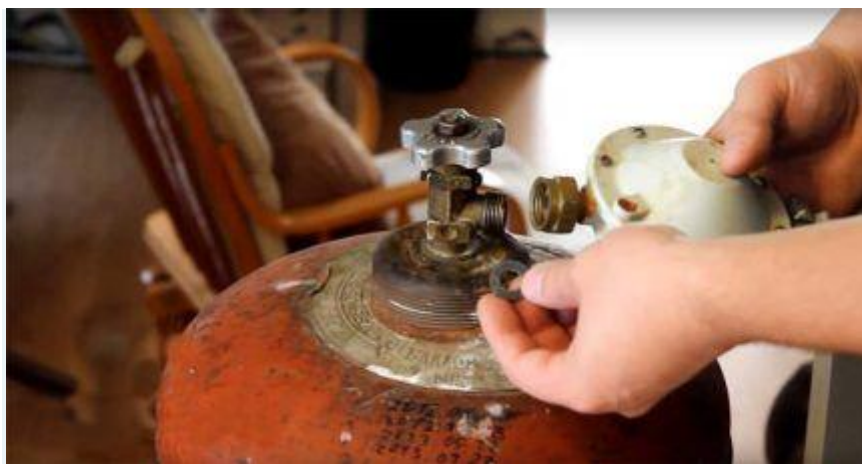
При соединении резьбовых соединений нужно предварительно намотать 3-4 слоя газовой фум-ленты и произвести затяжку гайки с достаточным усилием
