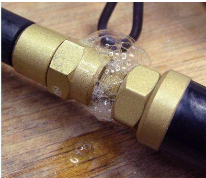
Мыльный раствор всегда помогает в выявлении недостаточной герметичности соединений
